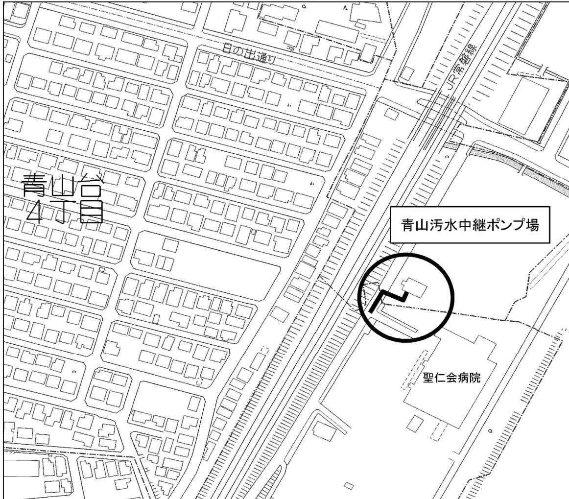
・圧送管閉塞工事(φ300) L=82m
