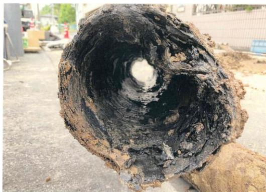
図 3.4-1 老朽化した管渠(Zパイプ)
